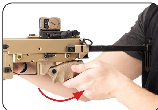
c. Prenez l'ensemble supérieur avec une main. Faites pivoter la poignée en position de départ jusqu'à ce qu'elle se verrouille.
