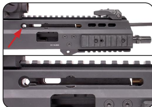
c. Insérez le levier d'armement dans le bon sens, pour que la goupille s'insère dans le support du levier d'armement.
