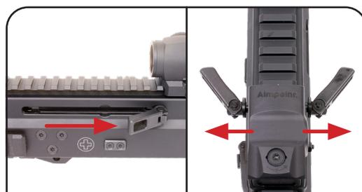
f. Poussez le support du levier d'armement par l'avant à l'aide de la tige de nettoyage.
