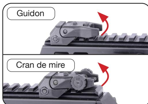
b. Poussez le cran de mire jusqu'à ce qu'il se verrouille en position verticale.
