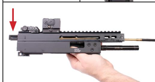
Le upper est maintenant démonté et prêt pour l'inspection et la maintenance.
