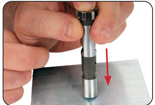
l. Retirez la goupille de verrouillage à l'aide d'un chasse-goupille.
