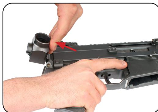
c. Déployez l'adaptateur jusqu'à ce qu'il se verrouille en place.
