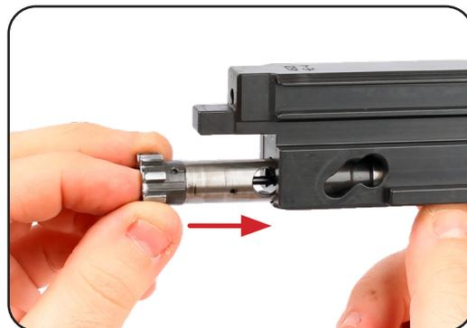
k. Alignez la tête de culasse avec la culasse, afin que l'extracteur soit orienté à 09h00 (en regardant par l'avant, côté tête de culasse).
