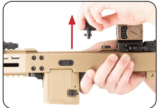
h. Den Verschluss hinten aus dem Gehäuse herausziehen.
