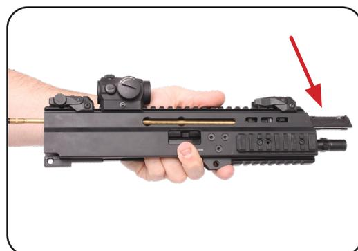
Das Gehäuse ist nun zerlegt und bereit zur Reinigung.
