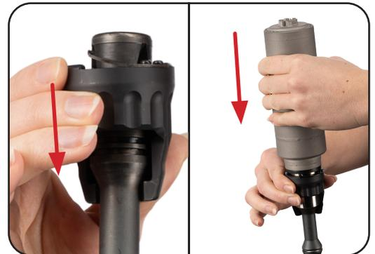
d. Dämpferkörper im Gegenuhrzeigersinn anziehen und dabei die Mutter festhalten. Den Dämpfer handfest anziehen.
