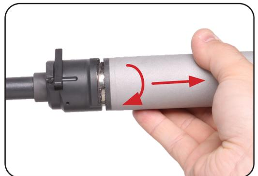
b. Die Drücker nach links drücken und den Schieber bis zum Anschlag herausziehen.
