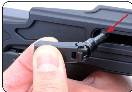
n. Sicherstellen, dass der Ladegriff korrekt sitzt, bevor der Schlitten nach hinten gezogen wird.
